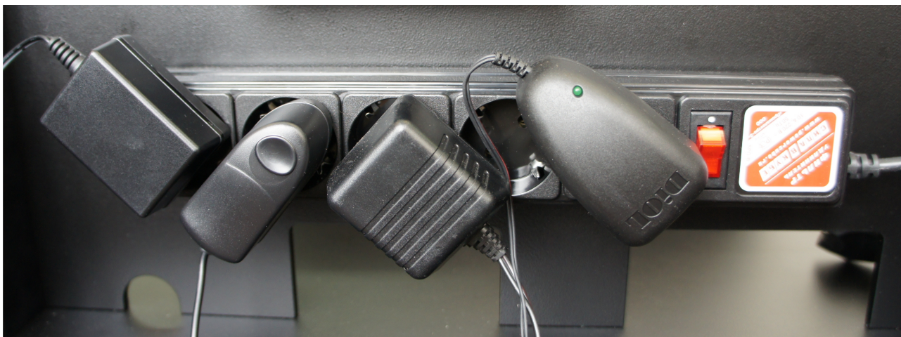
Рисунок 8 – Подключение блоков питания к сетевому фильтру. Слева направо: блоки питания весов, анализатора, насоса и мешалки
